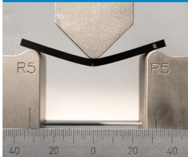
Biegeprüfung an PP-GF nach DIN EN ISO 178
