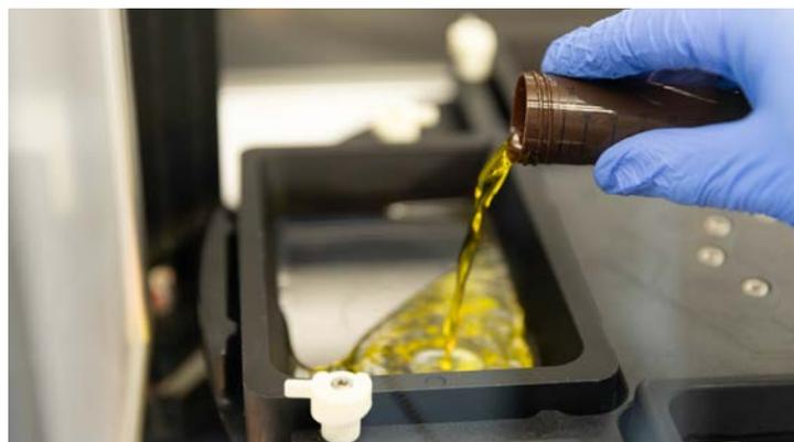
Vor dem Druck wird der Bioprinter mit entsprechender Biotinte befüllt. In dieser befinden sich alle für die Photopolymerisation wichtigen Komponenten und im Falle eines zu druckenden Gewebes auch menschliche Zellen.
