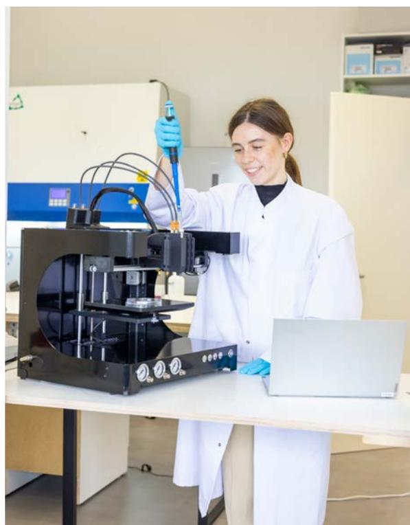
Befüllung des Hydrogelreservoirs eines 3D-Biodruckers
